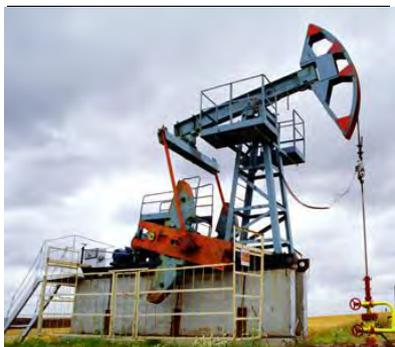
Рис. 1: Станок-качалка.
